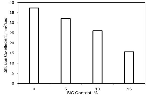
**Fig.50. Diffusion Co-efficient v/s wt % of SiC.**
